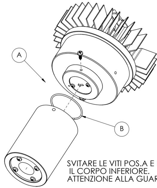
SVITARE LE VITI POS.A E RIMUOVERE IL CORPO INFERIORE. ATTENZIONE ALLA GUARNIZIONE POS.B.
