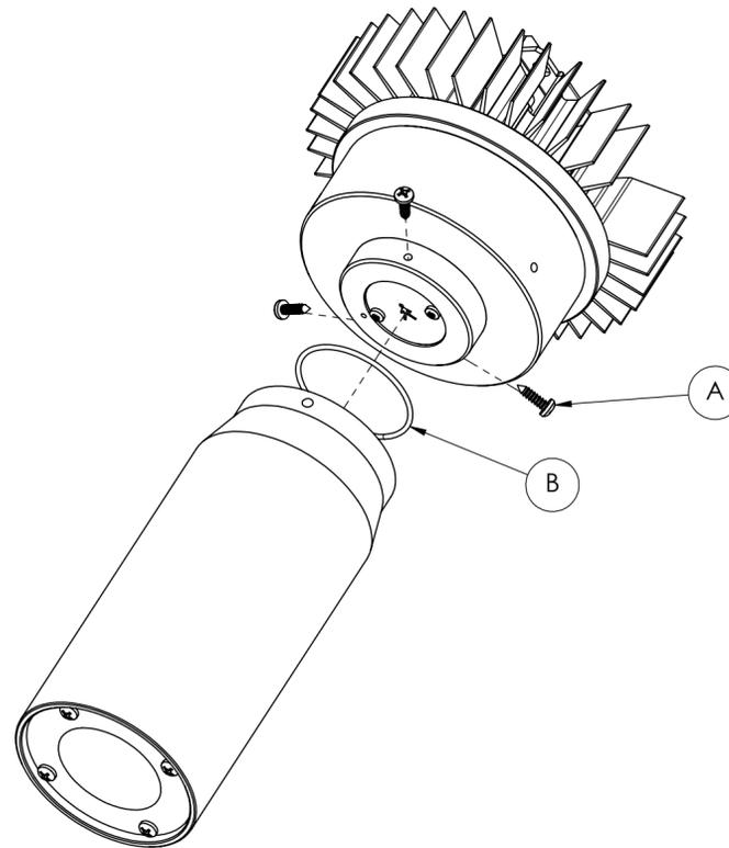
AVVITARE IL CORPO INFERIORE UTILIZZANDO LE VITI POS.A. LA GUARNIZIONE POS.B DEVE ESSERE INSERITA NELL'APPOSITA SEDE.
